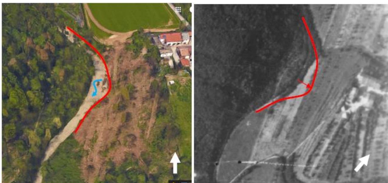
Figura 22: argine sinistro in erosione, in località C.na Campaccio. (Sinistra ortofoto Google 2016, destra foto aerea IGM 1936)
